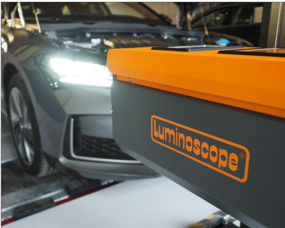
Digitales Scheinwerfer-Einstell-Prüfgerät (SEP) mit automatischem Nivellierausgleich
